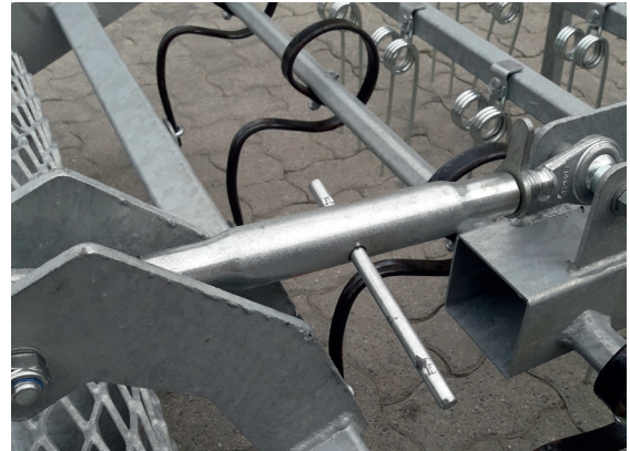
Tiefeneinstellung über Verdrehspindel
