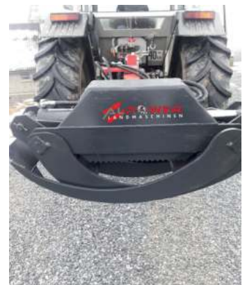
enger Greiferschluss von 8 cm
