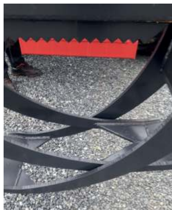
ineinander greifende Zange aus Hardox
