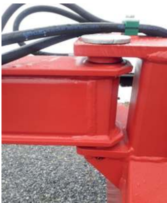
Stabiles Schwenkwerk mit Schmiernippel
